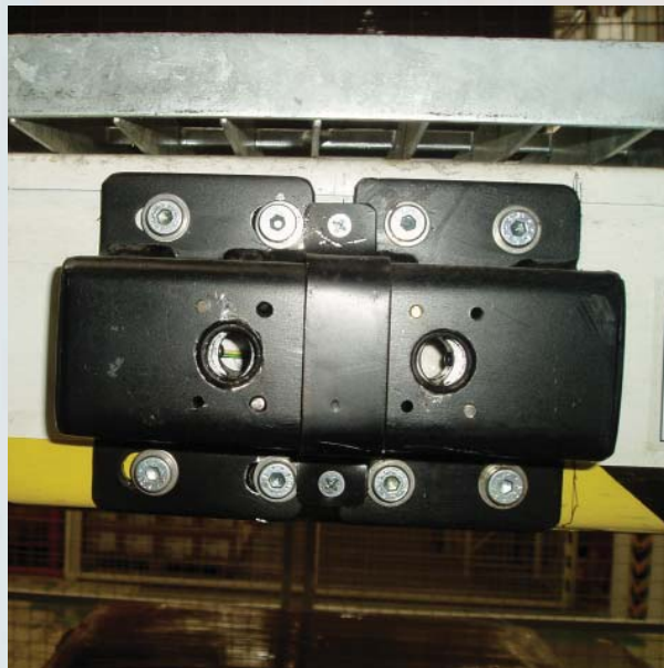
Montáž zámků INTERLOCK na pevnostní regál
