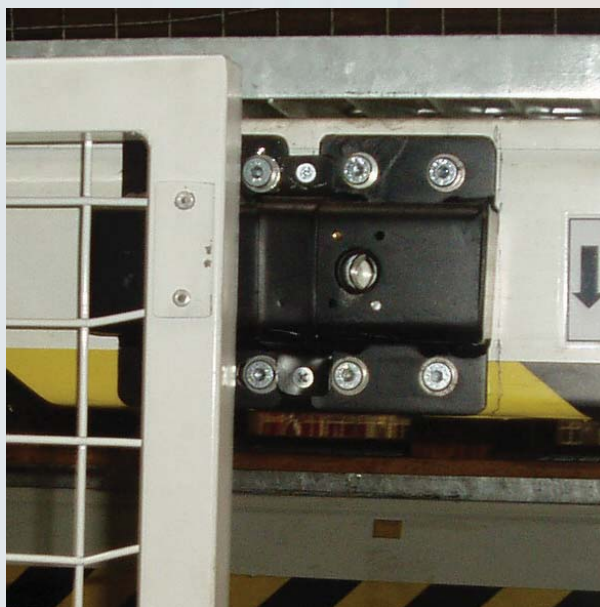
Kolík je instalován v drátěné bráně
