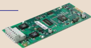
NIF600-1 NIFR600-1 Modul síťového rozhraní standardní / s redundancí - RS485 - Max. 1200 m
