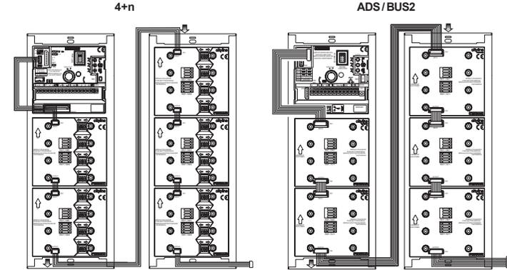
**FERMAX** CABLE CONEXIÓN PLACAS NCITY MODULARES Ref. 2540/2541
