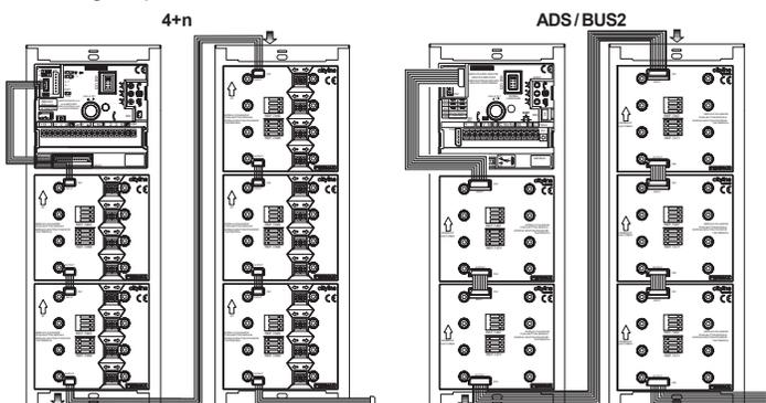
**FERMAX** CÂBLE CONNEXION PLATINES NCITY MODULAIRES réf. 2540/2541
