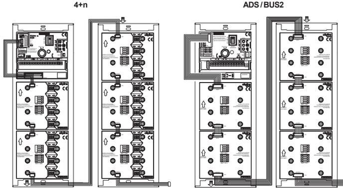
**FERMAX** CABLE CONEXIÓN PLACAS NCITY MODULARES Ref. 2540/2541
